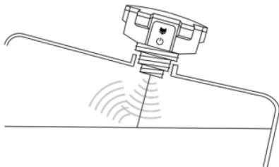
Der OilFox muss senkrecht in einem Winkel von  $90^\circ$  zur Oberfläche der zu messenden Flüssigkeit eingebaut werden, sonst kann das reflektierte Ultraschallsignal nicht empfangen werden.
