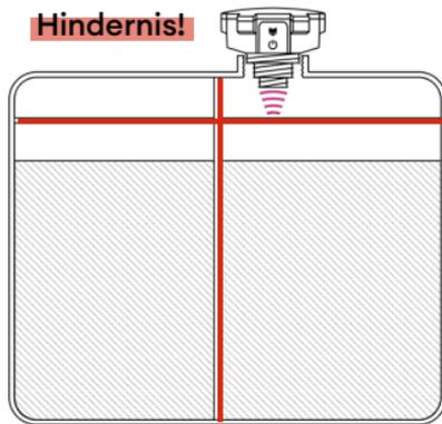
Querverstrebungen, Verrohrungen oder Einbuchtungen am Tank, die im Messkegel des OilFox-Ultraschalls liegen, können zu Verfälschungen der Messung führen.
