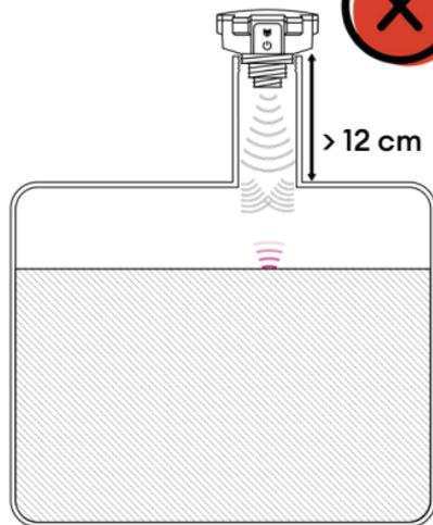
Sollte der OilFox auf einem Rohr montiert werden, darf dieses höchstens 12 cm lang sein. Ansonsten kann es zu einer Störung der Messung kommen.
