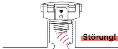
Bei der Montage des OilFox ist darauf zu achten, dass das Ultraschallsignal nicht von etwaigen Hindernissen im Nahfeld beeinträchtigt wird. Dazu gehören:
